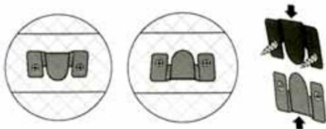
Il collegamento tra gli elementi è realizzato mediante agganci metallici a congiunzione.
