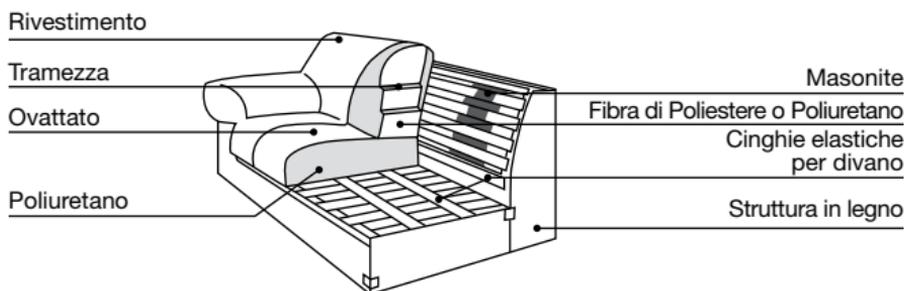
**Il poliuretano espanso** giunge in blocchi di diversa densità. La densità di ogni blocco è garantita da un certificato di analisi chimica e viene testata periodicamente sottoponendo il poliuretano ad un certo numero di battute per verificarne la resistenza all'uso.
